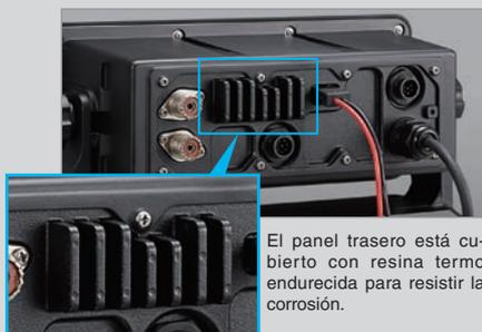
El panel trasero está cubierto con resina termoendurecida para resistir la corrosión.
